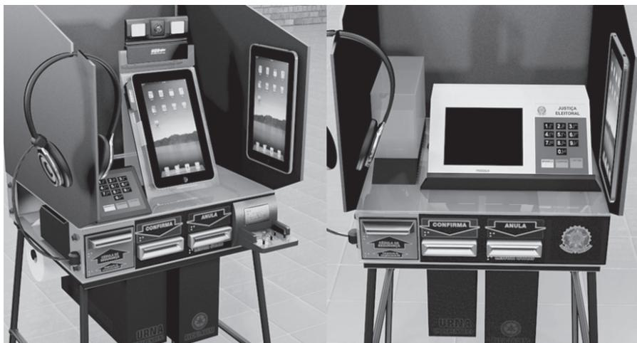
**Figura 4 - À esquerda, Mesa Receptora com DRE Tablet e à direita, DRE Urna Eletrônica**
