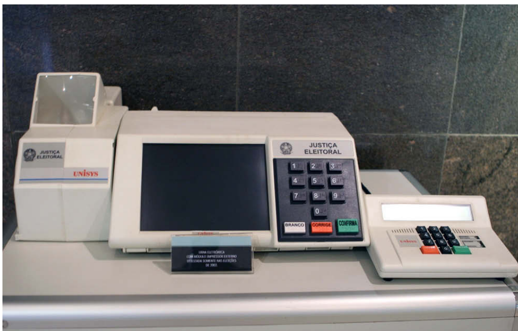
Figura 5.9 – A Urna Eletrônica 2002, com Módulo Impressor Externo (MIE).
