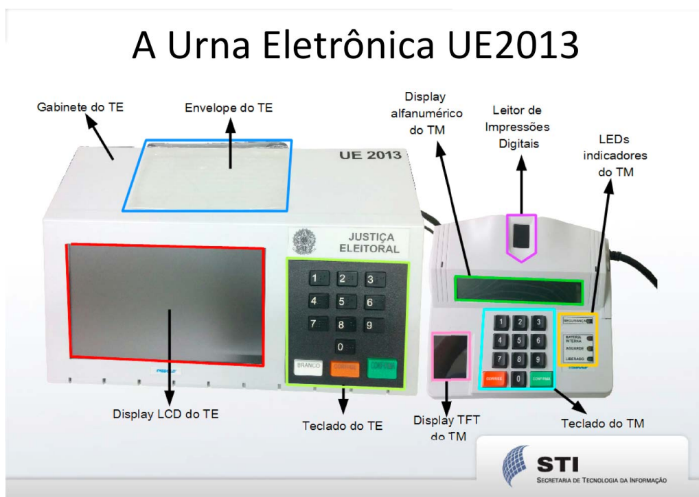
Figura 4.1 – A Urna Eletrônica 2013 – Detalhamento frontal TE e TM.
