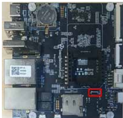
Figura 3: Placa BeaglePlay®, com o diodo em curto sinalizado (Reprodução: Própria)
