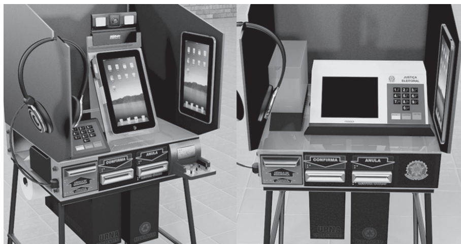
Figura 4 - À esquerda, Mesa Receptora com DRE Tablet e à direita, DRE Urna Eletrônica
