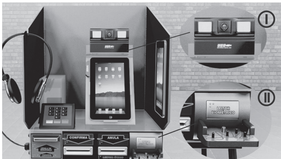
Figura 2 - Mesa Receptora e Leitores Biométricos
