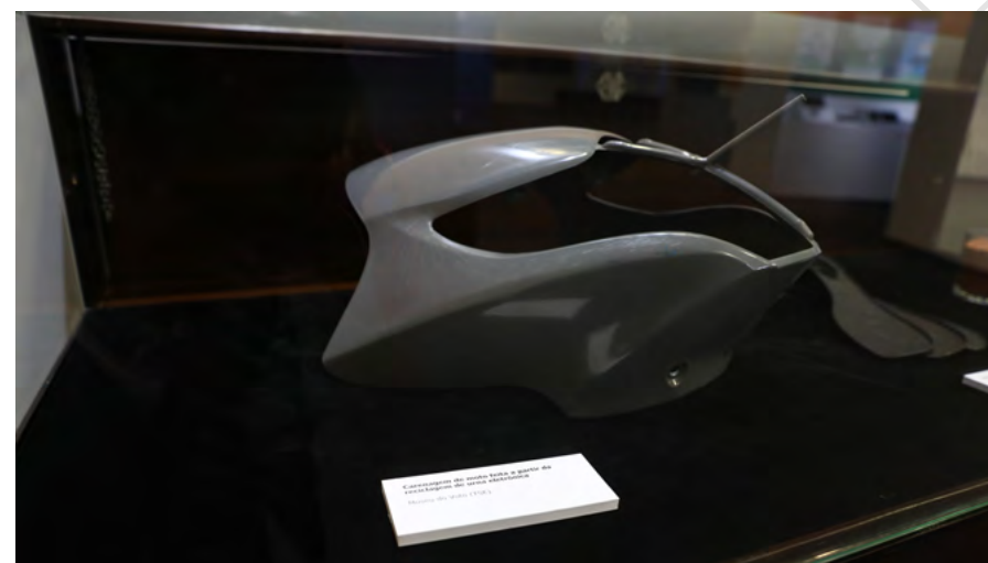
Carenagem de moto feita a partir da reciclagem de urna eletrônica Museu do Voto (TSE)
